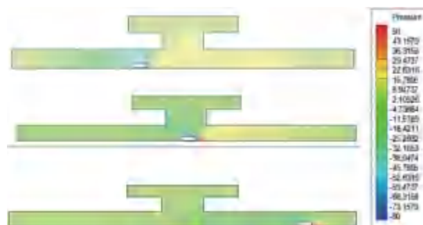
图4 隧道中车辆在不同位置时压力场分布
